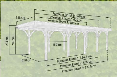
▶ **PREMIUM CARPORT EINZEL 3**, in KDI, inkl. einem Einfahrtsbogen mit Zubehör (gegen Aufpreis): 4 Seitenwände KDI / 1 Rückwand KDI / 11 H-Pfostenanker
