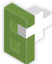
Die patentierte 6-Plus-Eck-Verbindung verknüpft die Bohlen mittels Verschraubung. Es ist keine Gewindestange als Wandsicherung nötig und somit entfällt die Wartung dieses Systems.
